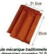
Tuile mécanique traditionnelle, à côte. dimensions courantes 21,5/35cm 13 à 20 tuiles/m 2
