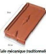
Tuile mécanique traditionnelle, losangée, dimensions courantes 21,5/35cm, 13 à 20 tuiles/m 2
