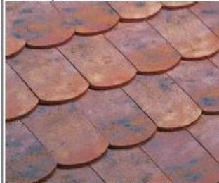
Tuile plate à emboîtement, écailles (22/m 2 ). Le recouvrement est minime, ce qui donne des toitures plus raides, moins épaisses, donc plus éloignées des toitures traditionnelles en tuiles écailles
