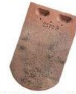
Tuile plate traditionnelle, écaille Petit moule : dimensions courantes 17/27 cm, 60 tuiles/m 2
