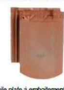
Tuile plate à emboîtement, écaille Petit moule : dimensions courantes 23,5/32cm, 22 tuiles/m 2
