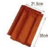
Tuile mécanique traditionnelle, à côte. dimensions courantes 21,5/35cm 13 à 20 tuiles/m 2
