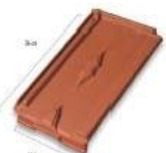
Tuile mécanique traditionnelle, losangée, dimensions courantes 21,5/35cm, 13 à 20 tuiles/m 2
