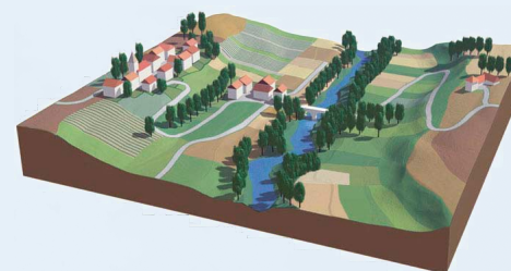
Lit mineur : constitué par le lit ordinaire du cours d'eau, pour le débit d'étiage ou pour les crues fréquentes (annuelles).
