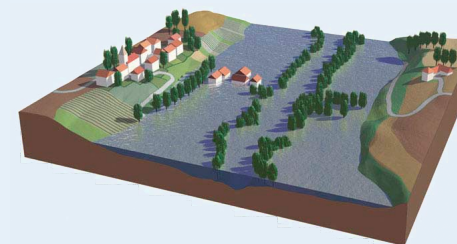
Lit majeur : comprenant les zones basses situées de part et d'autre du lit mineur, sur une distance de quelques mètres à plusieurs kilomètres. Sa limite est celle des crues exceptionnelles.
