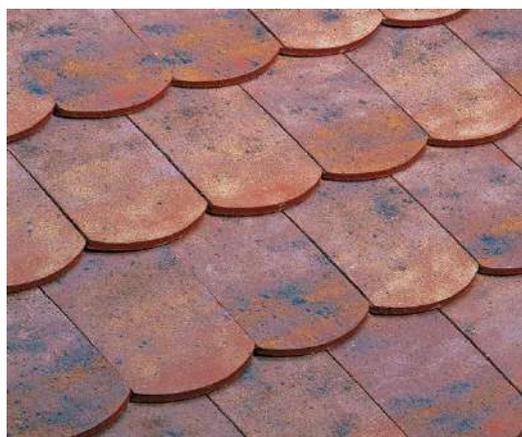
Tuiles plates à emboîtement, à petit moule, écailles (22 tuiles/m<sup>2</sup>). Dimensions courantes 23,5/32cm.
