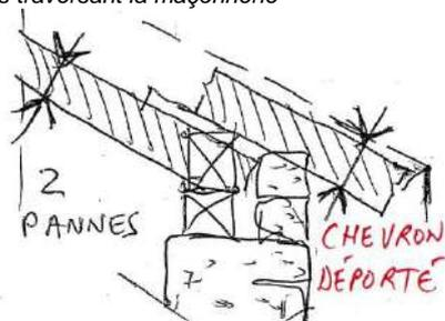
Système avec rehausse de l'avant-toit avec chevron déporté. Finesse du toit respectée.
