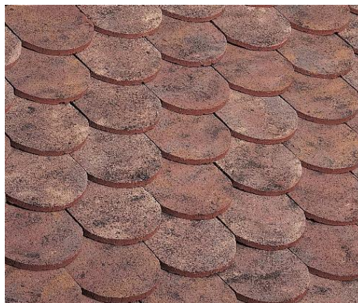
Tuiles plates traditionnelles, à petit moule, écailles (60 tuiles/m 2 ). Dimensions courantes 17/27 cm
