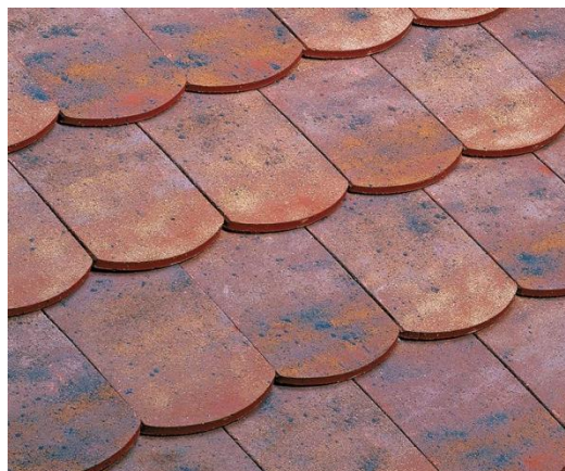
Tuiles plates à emboîtement, à petit moule, écailles (22 tuiles/m 2 ). Dimensions courantes 23,5/32cm.
