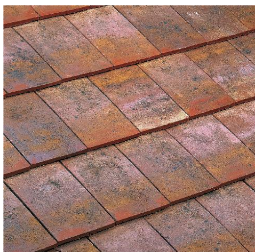
Tuiles plates à emboîtement, à petit moule, rectangulaires (22 tuiles/m 2 ). Dimensions courantes 23,5/32cm.
