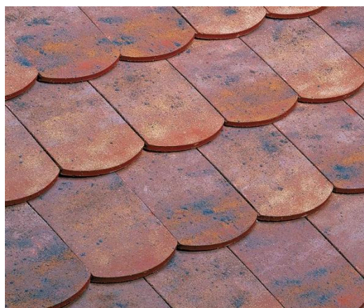
Tuiles plates à emboîtement, à petit moule, écailles (22 tuiles/m 2 ). Dimensions courantes 23,5/32cm.
