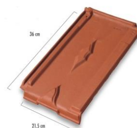
Tuile mécanique traditionnelle, losangée. dimensions courantes 21,5/35cm, 13 à 20 tuiles/m 2
